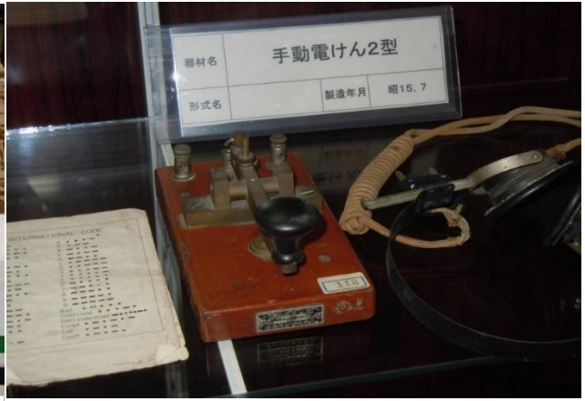
当時の海軍が使っていたモールス信号用電鍵 とレシーバー (久里浜通信学校歴史館所蔵)
