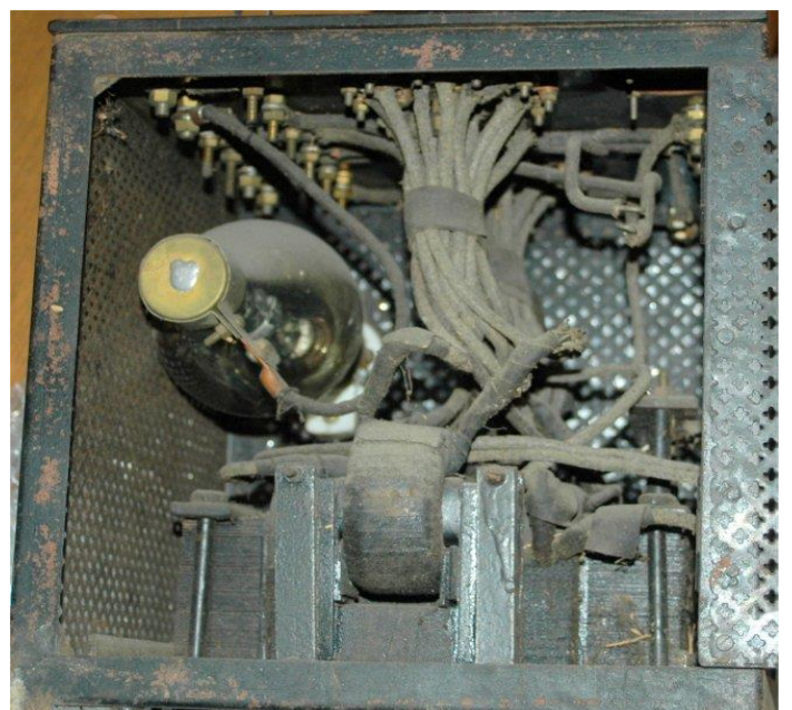
タンガー式整流充電器の内部 タンガーバルブが見える
