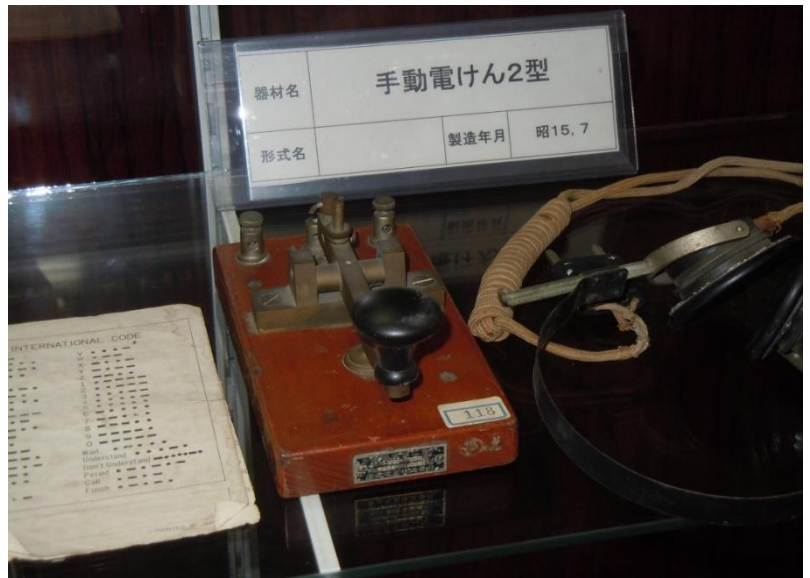
当時の海軍が使っていたモールス信号用電鍵と レシーバー (久里浜通信学校歴史館所蔵)
